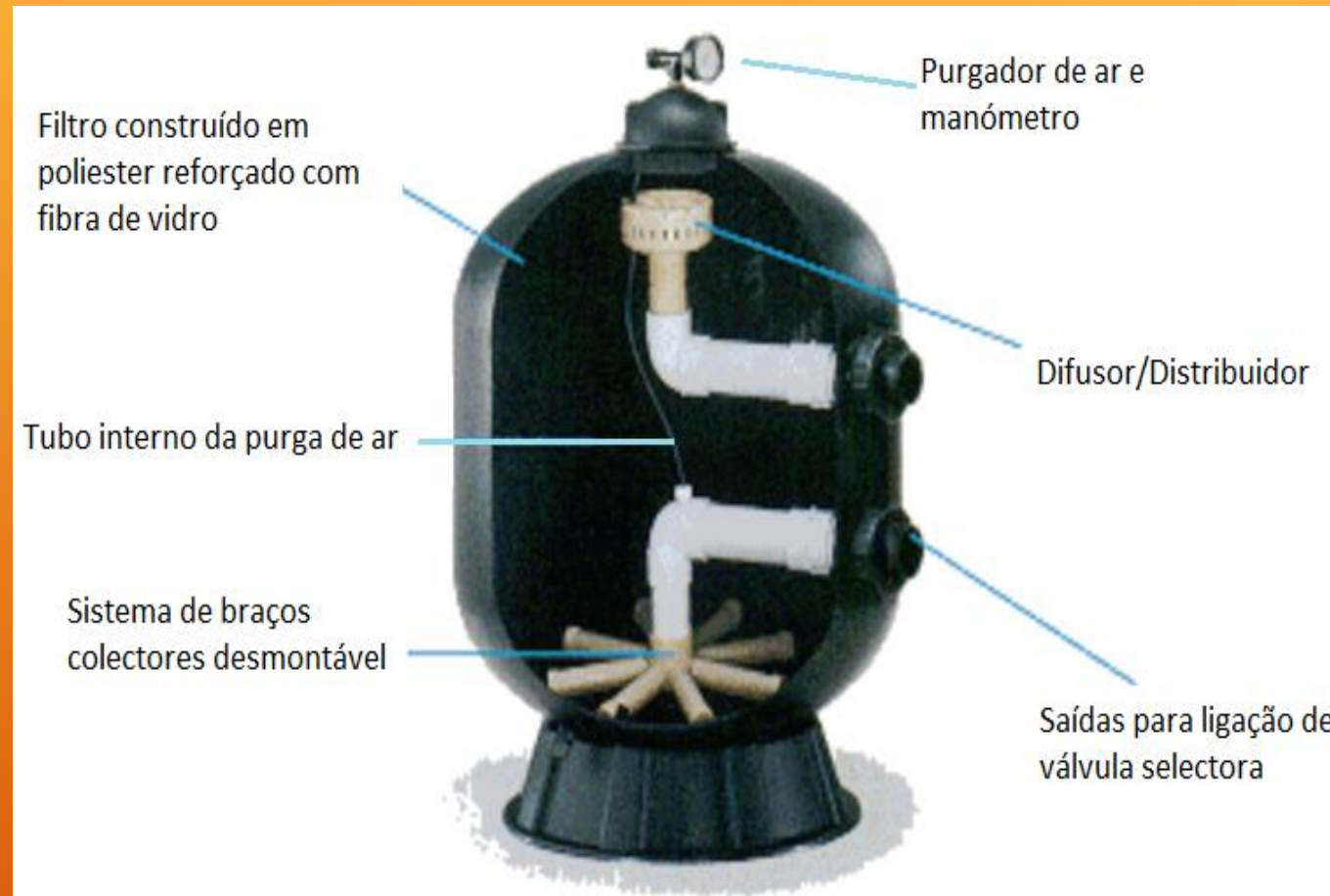
Fig. 4: Filtro de areia vertical com recolha por coletor ramificado
