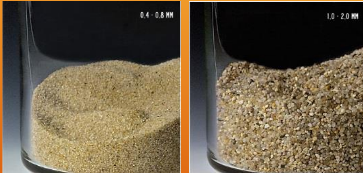
Fig.5: Exemplos de granulometrias de areia (0,4 – 0,8 e 1,0 – 2,0 mm)
